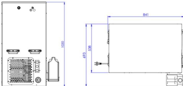
Nos refroidisseurs sont composés d'une enceinte isolée à double circuit qui accumule des frigoris importantes par formation de glace dans l'eau de la cuve.
