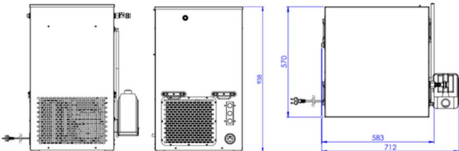
Nos refroidisseurs sont composés d'une enceinte isolée à double circuit qui accumule des frigoris importantes par formation de glace dans l'eau de la cuve.
